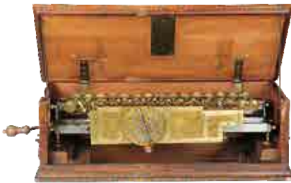
Fig. 1.1 (d) Stepped Reckoner or Leibniz wheel
